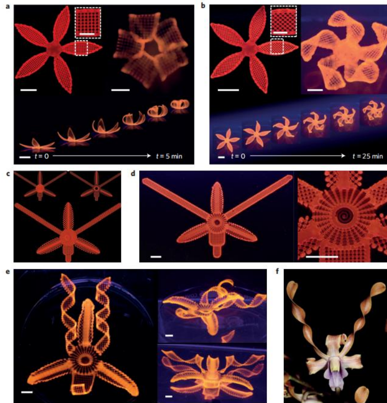
Figure 1.24 Morphologies complexes de fleurs générées par impression biomimétique. a,b, Fleurs simples composées de bilames à 90^\circ/0^\circ et -45^\circ/45^\circ orientés par rapport à l'axe longitudinal de chaque pétale (barres d'échelle, 5 mm, encart = 2,5 mm) inspirées par une orchidée native, le Dendrobium helix . [10]
