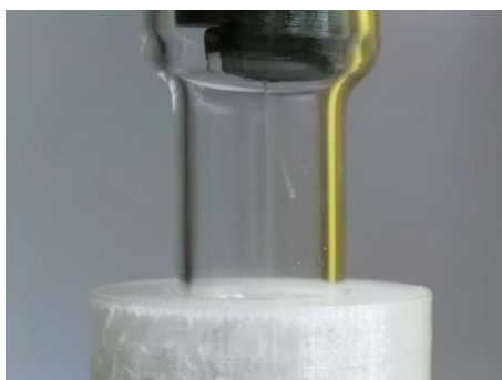
Figure 4.4 Actionnement d'un bilame en flexion.
