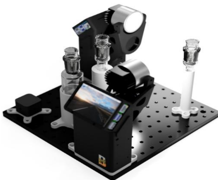
Figure 4.1 Design par CAO d'un banc de mesure optique automatisé pour suivre les déformations complexes 3D d'actionneurs souples biomimétiques.
