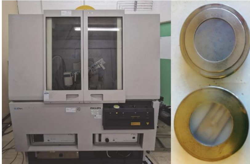
Figure 41°: Diffractomètre X'Pert Pro avec deux portes échantillons en silicium et en verre dépoli
