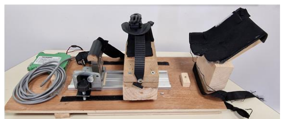
Figure 33 : Illustration des ergomètres de mesure de force élaborés en collaboration avec l'entreprise Dessintey.
