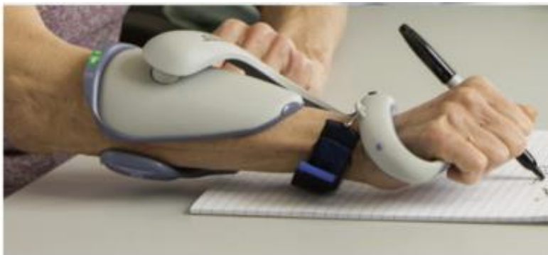
Figure 12 : Illustration d'une neuroprothèse stimulant l'extension du poignet et des doigts via un bouton déclencheur externe (Bioness Corp, H200) (Fu & Knutson, 2019).
