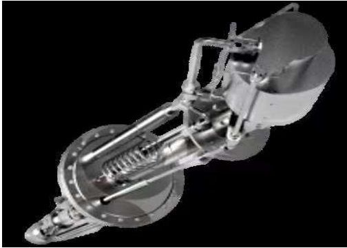
Figure III.3. Cathode magnétron conçue avec translation et inclinaison.
