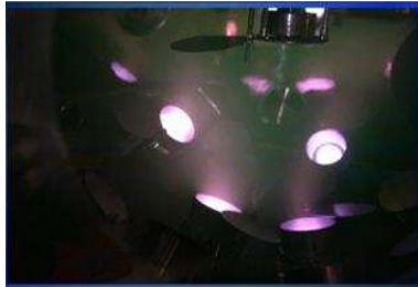
Figure IV.1. Cathodes avec leurs plasmas dans l'enceinte de la pulvérisation cathodique.
