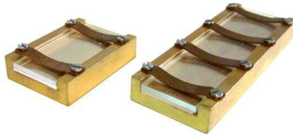
FIG. III.10 Cristaux Covesion de 20 et 40 mm intégrés dans des fours et protégés par une plaque de silice qui permet aussi d'uniformiser la température.
