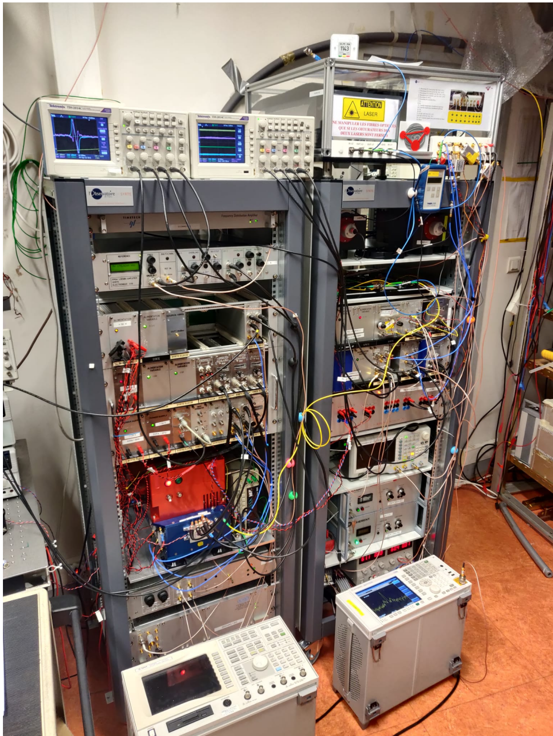
FIG. II.50 Photographie du dispositif complet livré au CNES lors de son développement au SYRTE (schéma en Figure II.1). À gauche la référence de fréquence, à droite les lasers Nd:YAG.
