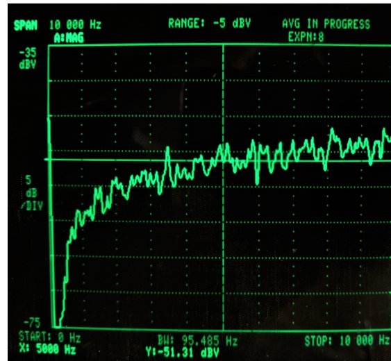
FIG. II.12 PSD du signal d'erreur lorsque le laser est asservi en fréquence. Entre 0 et 500 Hz, on voit l'effet du PI^2 avec une pente très forte, et entre 500 Hz et 5 kHz on voit l'effet du PI avec une pente moins forte. La rupture à 500 Hz n'est pas représentative de la bande passante de la PZT car l'appareil n'a pas une très bonne résolution fréquentielle aux basses fréquences avec une dynamique de 10 kHz.
