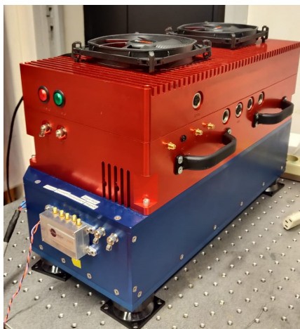
FIG. II.2 Photographie du système laser et du banc de spectroscopie dans leur boîtier respectif (rouge et bleu).
