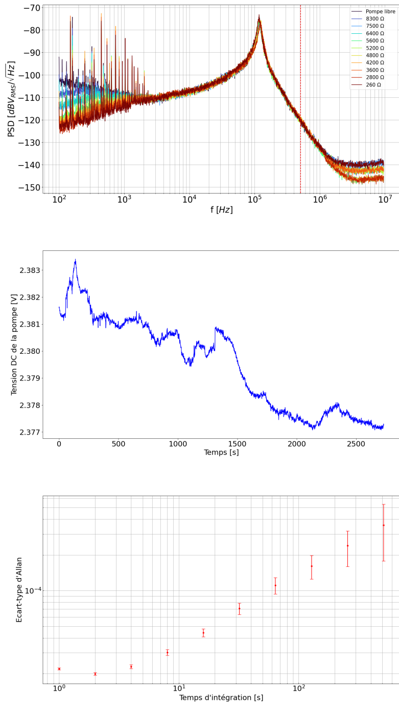
FIG. II.44 Caractérisation de l'asservissement en puissance de la pompe. En haut : PSD en sortie de la photodiode d'asservissement de puissance pompe. Au centre une mesure de la tension en sortie de photodiode de contrôle du faisceau pompe, en bas son écart-type d'Allan.
