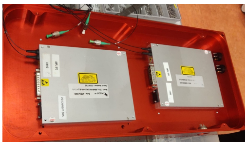
FIG. II.22 Photographie des deux EDFA en cours d'intégration.
