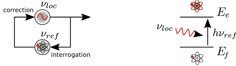
FIGURE 1 – Fonctionnement schématique d’une horloge atomique. La fréquence de l’oscillateur local \nu_{loc} est stabilisée sur la fréquence \nu_{ref} d’un oscillateur de référence, une transition atomique. C’est l’interrogation des atomes qui permet de produire un signal d’erreur, afin de corriger l’instabilité de l’oscillateur local par rapport à la réalisation atomique.
