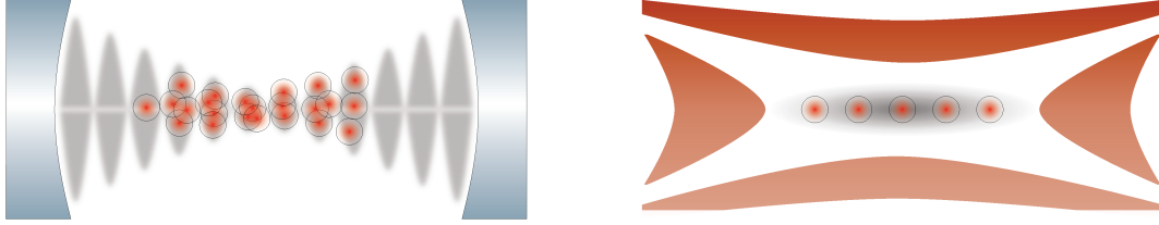
FIGURE 5 – Schéma des deux types de pièges mis en œuvre pour confiner les particules préalablement à leur interrogation avec le laser ultrastable.
