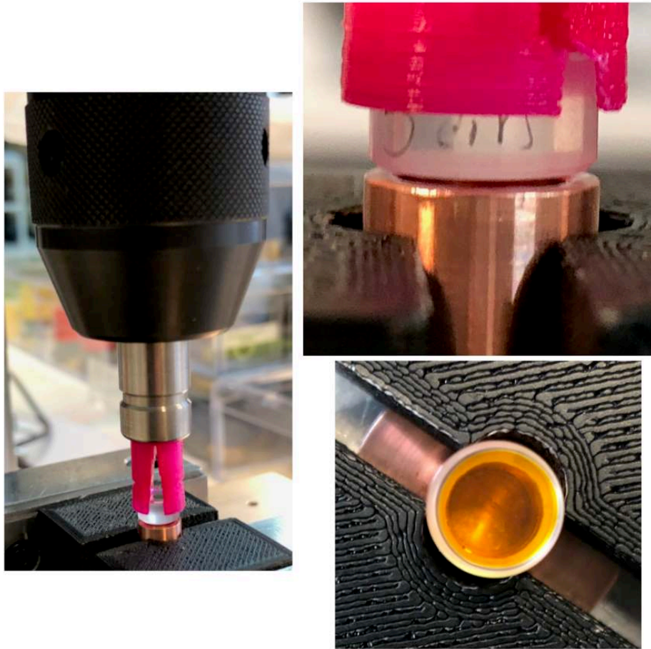
FIGURE IV.10 – Collage d’un des deux miroirs de la cavité optique sur sa lame flexible. Les deux pièces noires et la pièce en rose sont les pièces conçues et imprimées en 3D pour réaliser cet assemblage. Sur la photo de gauche, on peut voir le miroir dans la pince rose et suspendu au-dessus de l’entretoise, elle-même calée entre les deux pièces noires et pincée dans un étau. En haut à droite, une vue rapprochée des deux pièces en regard avant leur mise en contact. Leur maintien stable permet l’ajustement précis de leur position relative. À droite l’assemblage final vu du dessus. On peut voir la distribution de la colle sur le miroir par transparence, dont l’étalage est homogène et réduit à l’interface entre les deux pièces. La taille de l’accès optique n’est ainsi pas réduite par un excès de colle.
