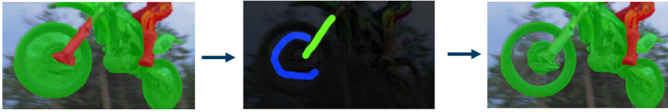
FIGURE 2.32 – Différentes étapes d'une étape de segmentation interactive. Tout d'abord, une prédiction de segmentation est produite. L'annotateur indique des corrections, qui seront effectuées par la méthode de segmentation interactive [16].
