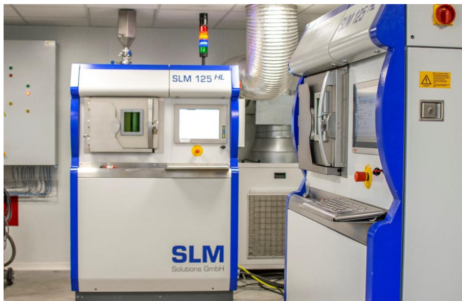
Fig. II-8 : Machine d'élaboration SLM 125 HL utilisée tout au long des travaux de thèse présentés dans ce manuscrit.
