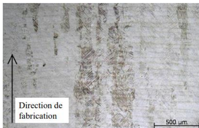
Fig. I-27 : Microstructure brute de fabrication type du Ti-6Al-4V élaboré par procédé L-PBF [99].
