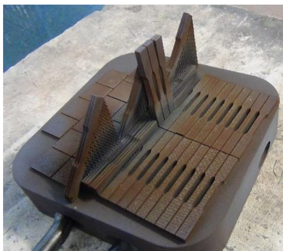
Fig. III-3 : Plateau d'éléments de caractérisation mécanique et microstructurale en Ti-6Al-4V ELI après traitement thermique.
