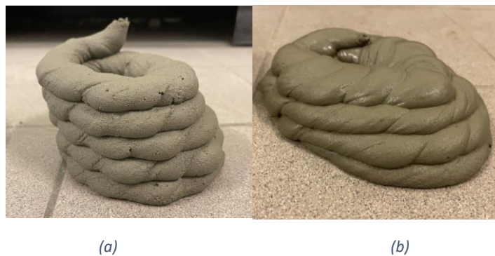
Figure 2.12: Couches d'un (a) matériau buildable, et d'un (b) matériau non buildable
