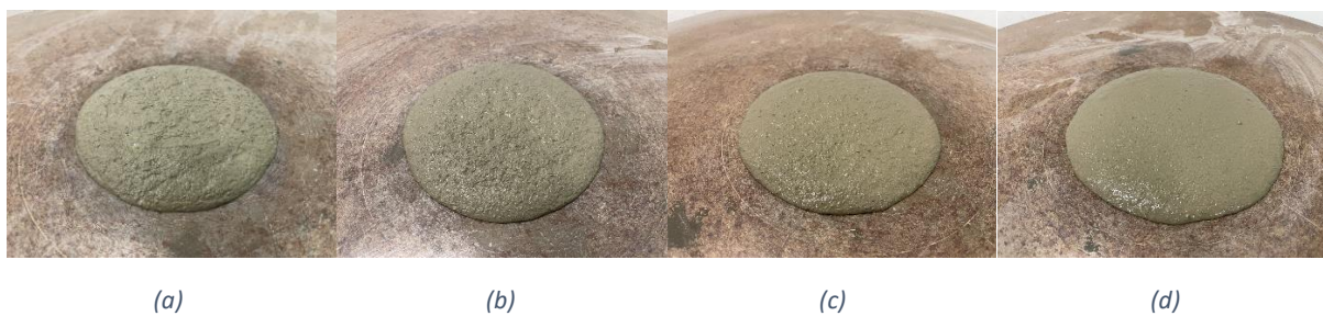
Figure 3.3: Étalement des mélanges avec (a) 0%, (b) 0,12%, (c) 0,24% et (d) 0,36% SP
