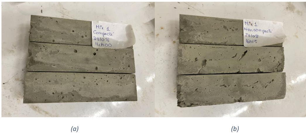
Figure 4.35: Aspect d'éprouvettes (a) compactées et (b) non compactées de la formulation F1
