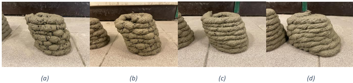
Figure 3.1: Extrudabilité des mélanges avec (a) 0%, (b) 0,12%, (c) 0,24% et (d) 0,36% SP
