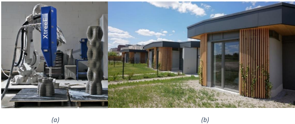
Figure 1.3: (a) Imprimante et (b) cinq maisons imprimées par XtreeE [19]
