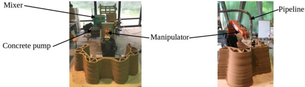
Figure 1.24: Mur isolant imprimé à base de terre, de sable et de ciment [209]
