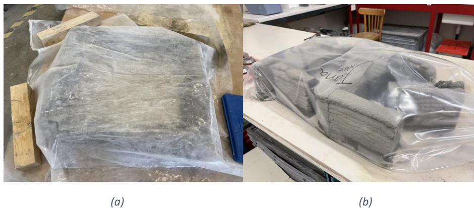
Figure 2.27: (a) Couverture du rectangle imprimé et découpé en blocs pendant 24 heures, et (b) stockage des blocs dans des sacs en plastiques jusqu'aux essais d'écrasement
