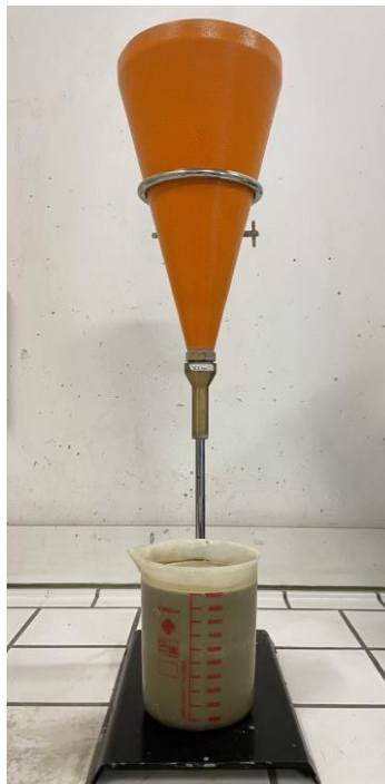
Figure 2.7: Cône de Marsh utilisé pour mesurer la saturation du liant en superplastifiant
