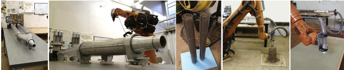
Figure 1.26: Système d'extrusion développé pour l'impression de torchis [211]
