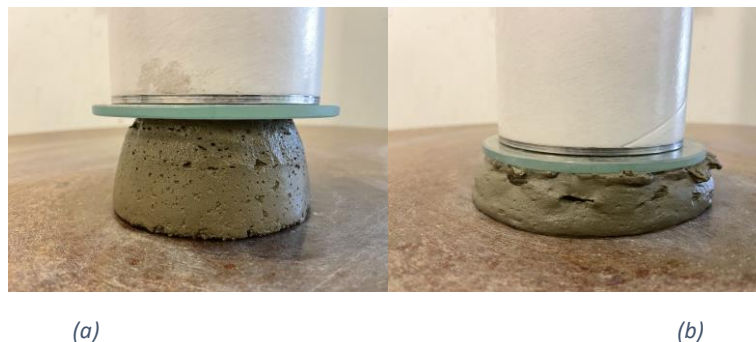
Figure 2.15: Hauteur finale ( h_f ) d'un (a) matériau buildable, et d'un (b) matériau non buildable mesurée avec l'essai de buildabilité
