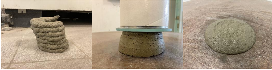
Figure 3.7: Extrudabilité, buildabilité et étalement de la formulation témoin
