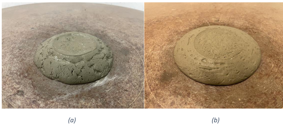
Figure 4.18: Etalement des mélanges de la Formulation 2 avec (a) 0,72% et (b) 0,75% SP
