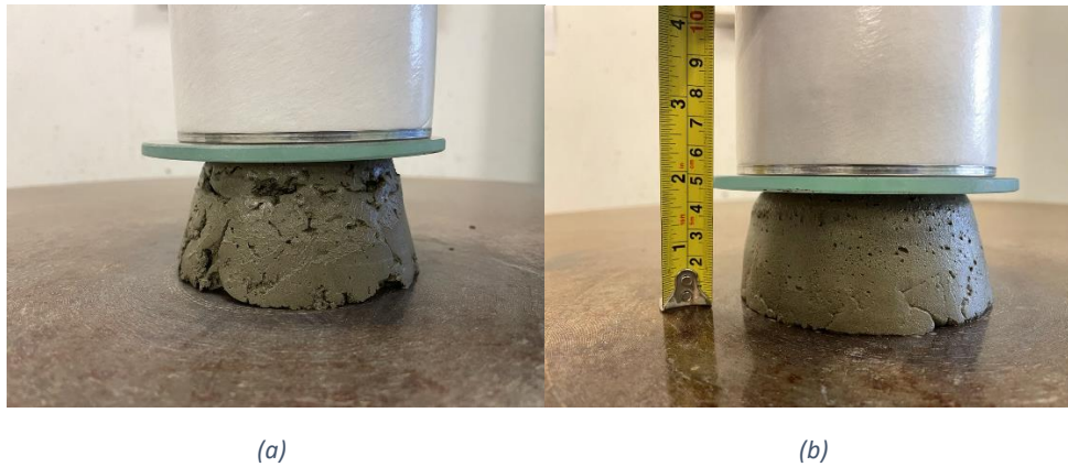
Figure 4.17: Buildabilité des mélanges de la Formulation 2 avec (a) 0,72% et (b) 0,75% SP
