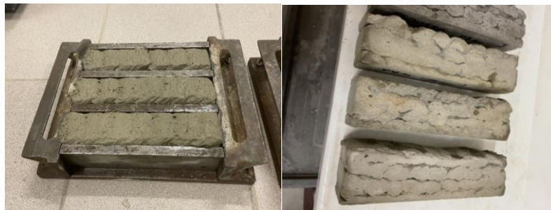
Figure 2.21: Buse rectangulaire (3 x 1 cm) utilisée pour impression à l'intérieur des moules
