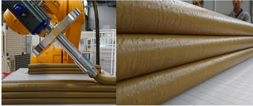
Figure 1.25: Matériau imprimé à base de terre et d'alginate [210]
