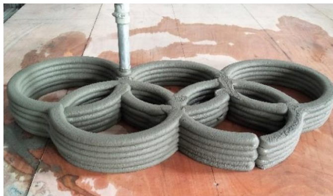
Figure 1.20: Mortier imprimable contenant des granulats recyclés avec des fibres de polyéthylène [178]
