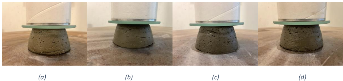
Figure 3.30: Buildabilité des mélanges (a) FS10L10, (b) FS10L20, (c) FS20L20 et (d) FS20L30
