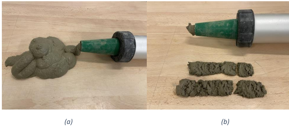
Figure 2.11: Extrusion d'un (a) matériau trop fluide, et d'un (b) matériau trop sec et dur à extruder
