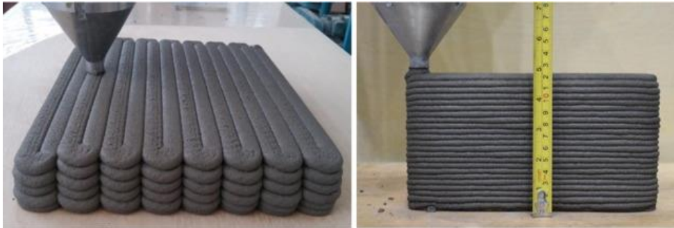
Figure 1.21: Produit final imprimé avec 0,5% de fibres de basalte [181]
