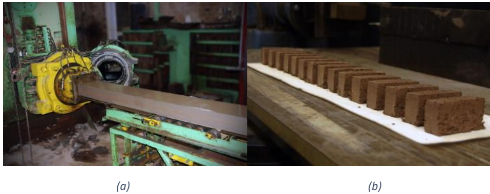
Figure 1.23: (a) Extrudeuse de briques commerciale et (b) briques extrudées dans un laboratoire [204]
