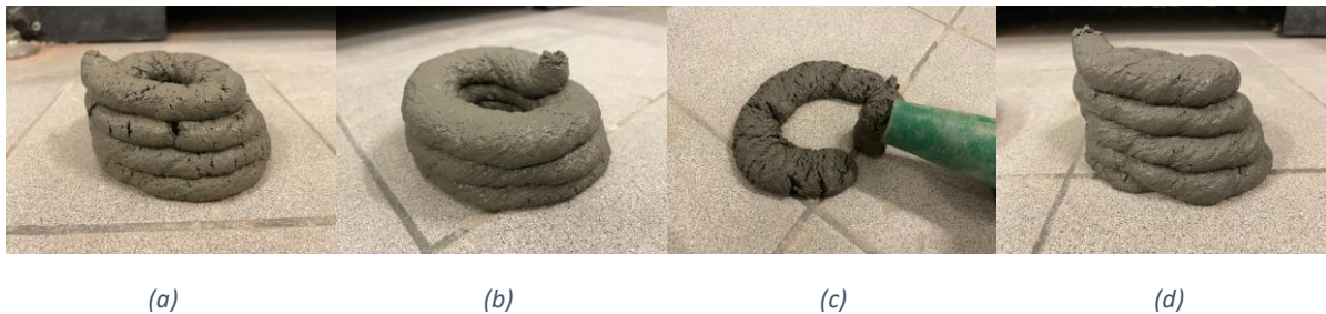
Figure 3.29: Extrudabilité des mélanges (a) FS10L10, (b) FS10L20, (c) FS20L20 et (d) FS20L30
