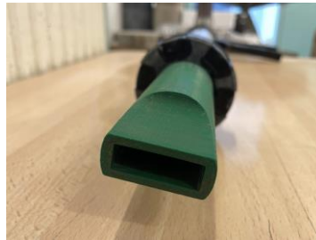
Figure 2.21: Buse rectangulaire (3 x 1 cm) utilisée pour impression à l'intérieur des moules
