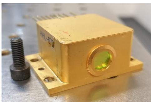
**FIGURE 1.16** – Photographie d'un packaging HHL (High heat load) pour QCL (Alpes Lasers). La sortie laser est visible en face avant, les broches d'alimentation à l'arrière. Pour comparaison, la vis mesure 1.7 cm de hauteur.
