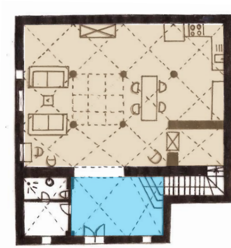
Figure 83 : Croquis du plan du rez-de-chaussée avec zones skifa et makhzen
