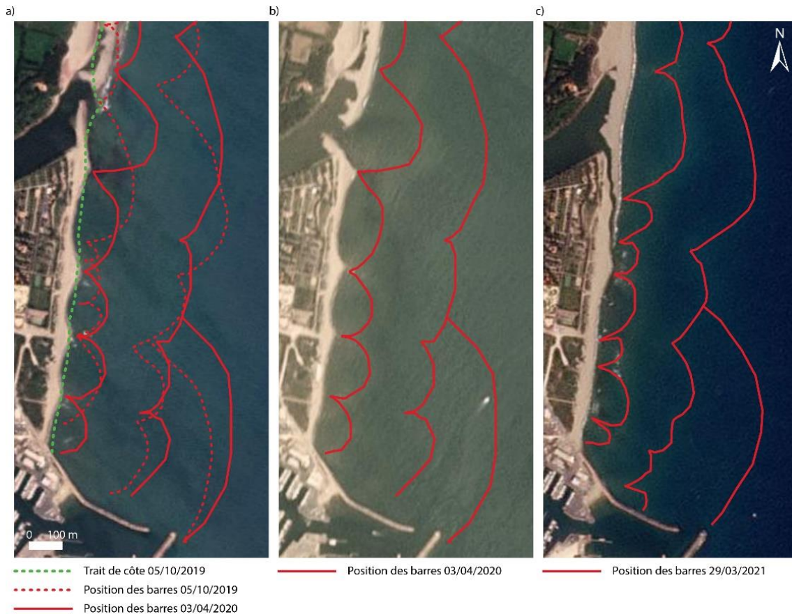
Figure IV.8 Rôle de l’impact des barres sur le trait de côte dans a) la mise en place d’une sinuosité de plage, b) la mise en place d’une sinuosité de plage à proximité de l’embouchure et c) en présence d’une migration importante de l’embouchure vers le sud.
