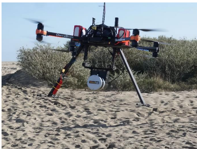
Figure III.9 : Déploiement d'un LiDAR YellowScan Surveyor monté sur un OnyxStar Altigator lors d'un levé sur l'embouchure de la Têt.
