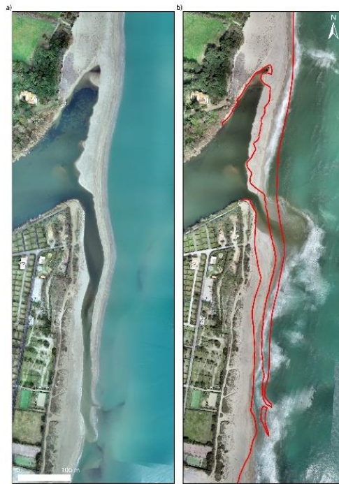
Figure IV.10 : Orthophotos drone montrant la morphologie de l'embouchure a) avant et b) après la tempête du 13/02/2022. Le trait rouge correspond à la position du trait de côte avant le passage de la tempête.
