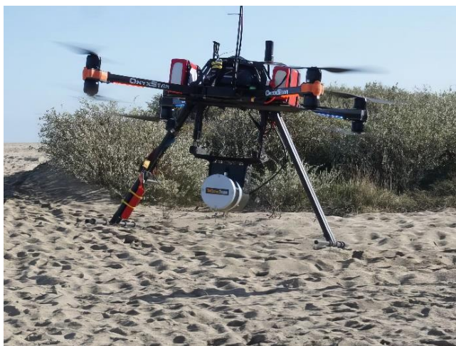
Figure III.9 : Déploiement d'un LiDAR YellowScan Surveyor monté sur un OnyxStar Altigator lors d'un levé sur l'embouchure de la Têt.
