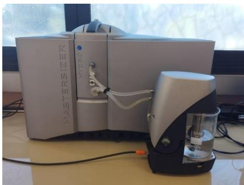
Figure III.17 : Granulomètre laser Malvern Mastersizer 3000 équipé d'une unité de dispersion.
