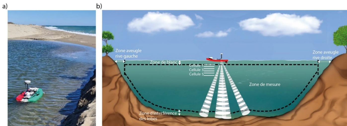
Figure III.3 : a) Déploiement de l'ADCP M9 sur son hydroboard télécommandée et positionné à l'aide d'une antenne Trimble R8s à proximité de l'embouchure de la Têt. b) Représentation schématique d'une mesure ADCP le long d'un transect et illustrant les zones mesurées et non mesurées.
