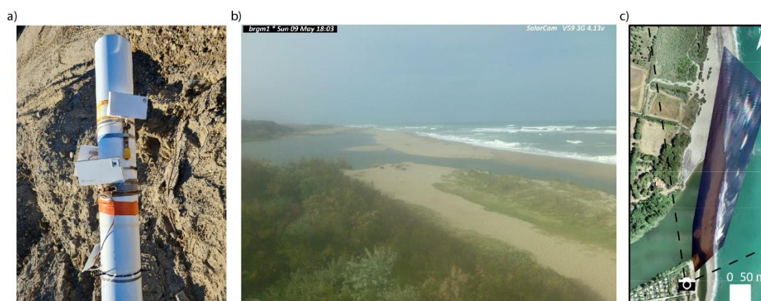
Figure III.13 : a) Photo du montage intégrant les deux SolarCam sur le mat. b) Image brute obtenue lors d'une tempête avec des houles de 2,5 m. c) Image ortho-rectifiée et géoréférencée obtenue en post-traitement.
