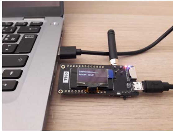
FIGURE 4.3 Capteur connecté à l'ordinateur qui effectue une transmission.
