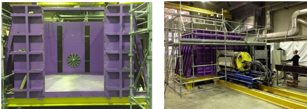
Figure 1-2 : Dispositif de tunnelier à pression de terre de l'ENTPE
