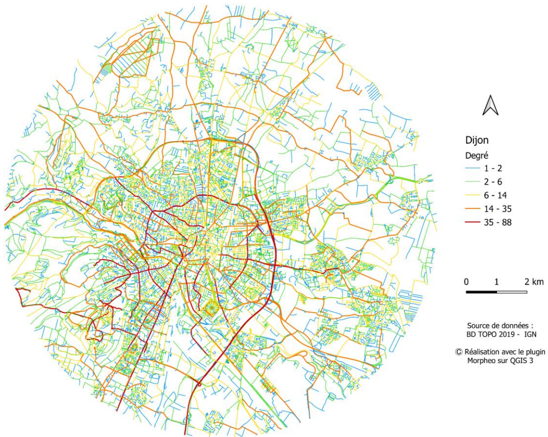
Figure 2.9. Le degré des voies calculé sur le réseau viaire de Dijon en 2019.
