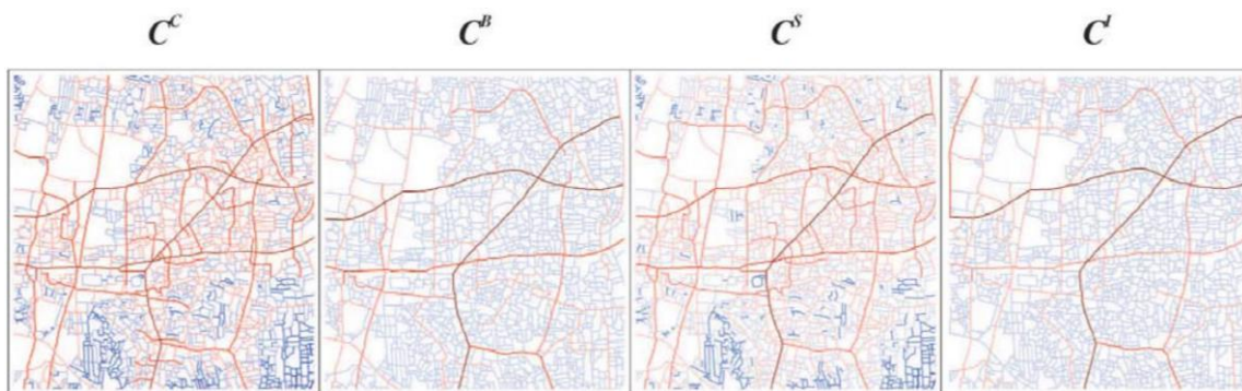
Figure 1.9. Approche duale : Quatres indicateurs de centralité centralité ( C^C = proximité, C^B = intercalation, C^S = rectitude, C^I = information) calculés sur le réseau viaire d'Ahmedabad représenté par un graphe dual (noeuds = routes , arcs = intersections). Source : Porta et al., 2006a.
