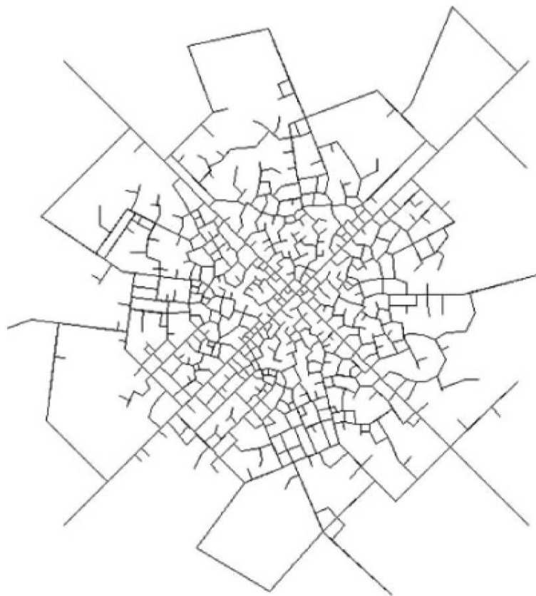
Figure 8.12. Le réseau viaire d'une ville simulé à partir de deux éléments structurants longs et perpendiculaires et avec des valeurs des paramètres d'étalement variables au cours du temps. Le centre historique de la ville a été construit avec un faible paramètre de construction et sans étalement ( \omega = 0,2 et f_{ext} = 0 ) pour rappeler l'aspect arborescent d'un souk central dans la Casbah. Ensuite, les paramètres sont modifiés à \omega = 0,8 et f_{ext} = 0,15 , ce qui crée une couronne industrielle. Le réseau simulé est nettement circulaire bien que les éléments structurants initiaux soient longs et perpendiculaires. Source : Courtat (2012).
