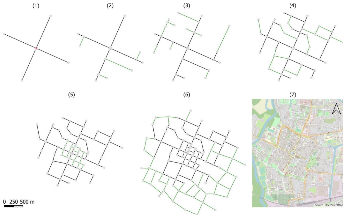
Figure 10.15. Simulation d'un réseau viaire correspondant) la forme "Radio-quadrillée". (1), (2), (3), (4) et (5) Graphes vaires résultants respectivement des séquences 1, 2, 3, 4 et 5 de la simulation. Les segments d'initialisation sont représentés en rouge sur le premier réseau (1), et les nouveaux segments sont représentés en vert. (6) Graphe vair résultant de la simulation. (7) Réseau réel de Vitry-le-François (France).
