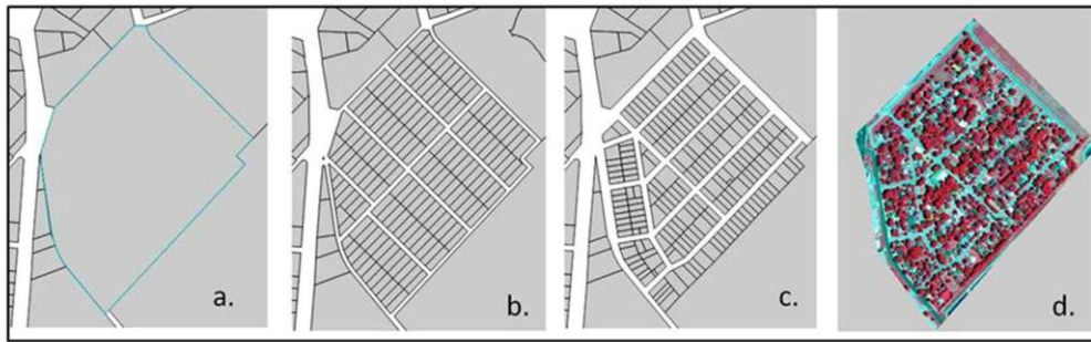
Figure 7.19. Subdivision d'une parcelle effectuée avec le modèle de Dahal et Chow (2014). a) parcelle candidate, b) îlots et rues modélisés, c) subdivision de la parcelle observée en réalité, et d) une ortho-photo de parcelle. Source : Dahal et Chow (2014).
