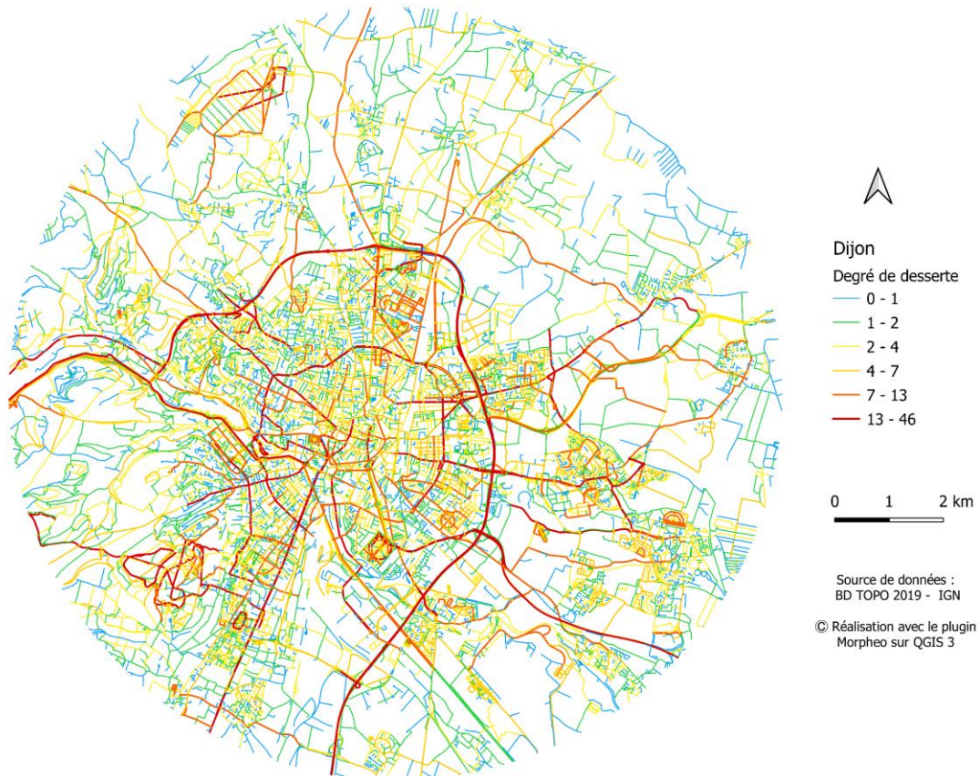
Figure 2.13. Le degré de desserte des voies calculé sur le réseau viaire de Dijon en 2019.
