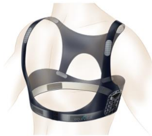
Figure 19. Représentation schématique de la ceinture thoracique utilisée pour enregistrer les signaux physiologiques des résidents.
