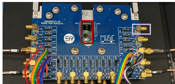
FIGURE V.13 – Image du dispositif expérimental. La carte électronique bleue est l'interface permettant l'accès aux électrodes de la puce microfluidique par les connecteurs SMA (dont un est encadré en violet). La puce microfluidique est encadrée en rouge.
