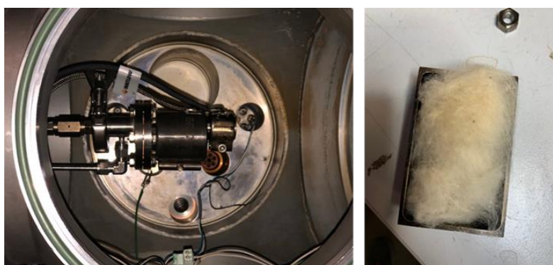
Figure 2. 8. Gauche : Photo du four sous-vide installé dans la chambre de jet utilisant une bride de 250 mm, droite : photo du réservoir où l'échantillon est placé entre deux morceaux de laine de roche.
