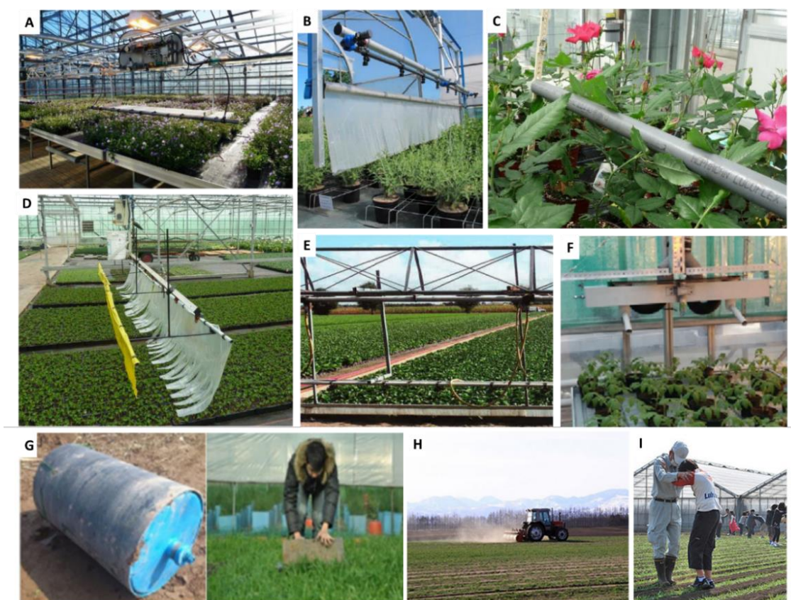
Figure 19. Quelques exemples de dispositifs et approches permettant de faire de la stimulation mécanique en production végétale. A : Bras mécanique équipé d'une bâche en plastique non frangée et utilisé sur des plantes ornementales (Börnke and Rocks, 2018) ; B, D : Charriot d'arrosage équipé d'une bâche en plastique frangée et d'une bande engluée jaune utilisé sur des arbustes ornementaux et jeunes plants (ASTREDHOR Sud-Ouest GIE Fleurs et Plantes, 2016) ; C : Bras mécanique équipé d'un tube en plastique utilisé sur des rosiers (Morel et al., 2012) ; E : Bras mécanique équipé de balais (Ferre, 2014) ; F : Dispositif de ventilation installé au-dessus de plants de tomates (Sparke et al., 2022) ; G : Rouleau utilisé manuellement sur une culture de blé (Si et al., 2019) ; H : Tracteur équipé d'un rouleau utilisé sur une culture de blé (Iida, 2004) ; I : Piétinement (mugifumi) réalisé par les agriculteurs sur une culture de blé (Iida, 2004).
