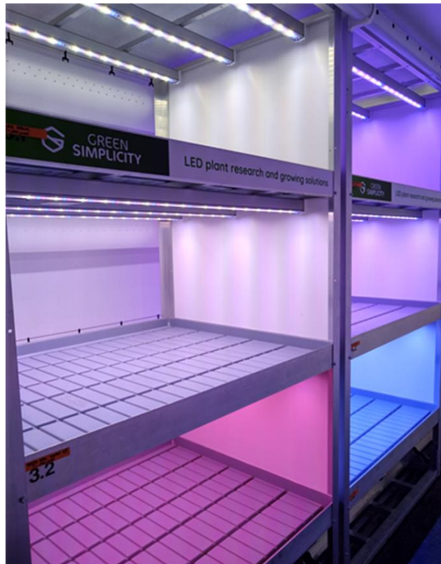
Figure 48. Chambre de culture (Green Simplicity) utilisée à des fins expérimentales et installée à l’entreprise Hortensia France.
