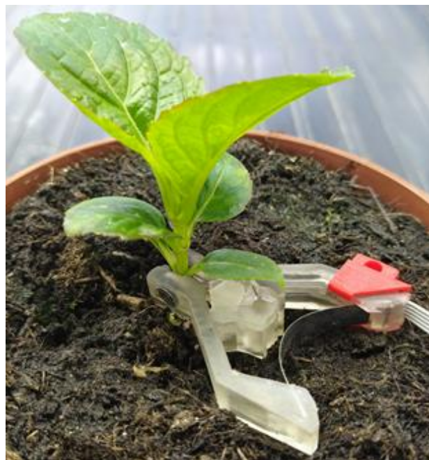
Figure 31. Pince dendrométrique utilisée pour étudier l'effet de la stimulation mécanique sur la croissance diamétrale des tiges d' Hydrangea macrophylla . Les pinces ont été placées au niveau du collet des tiges d'hortensia correspondant à l'entre-nœud le plus basal.
