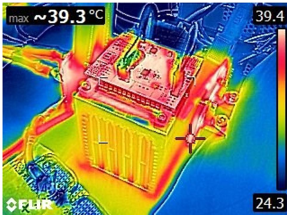
Fig. VI.19 : Mesure d'échauffement de l'électronique de puissance.
