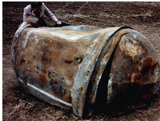
**FIGURE I.1.2** – Réservoir du second étage de la fusée Delta-II retombé proche de Georgetown, Texas, en janvier 1997
