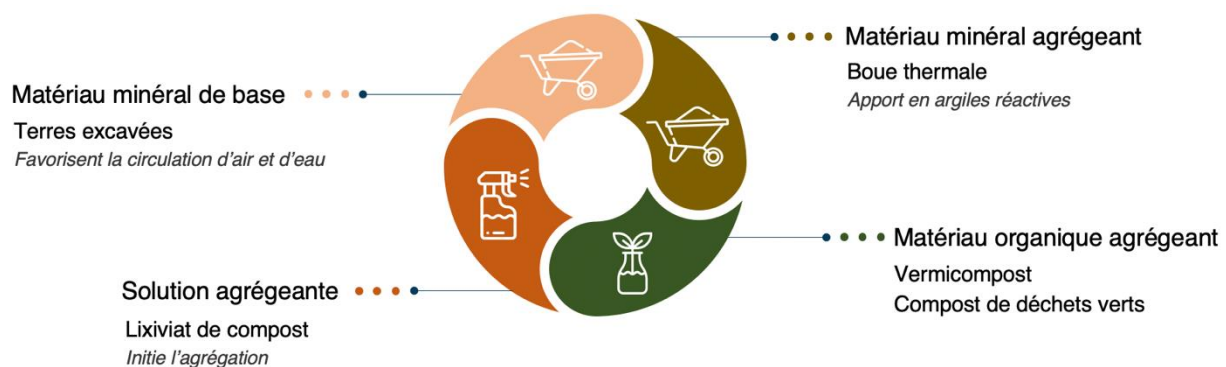
Figure V-2 : mélanges créés avec des matériaux argileux et organiques
