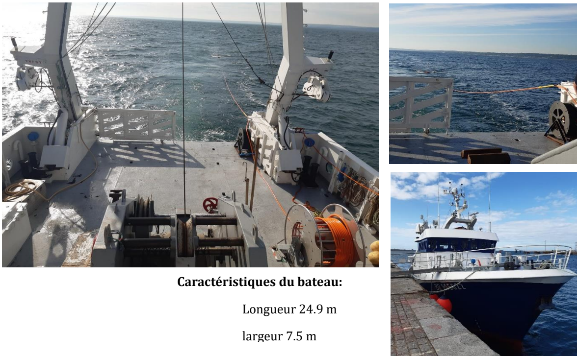
Figure 2. 29 : Installation de la flûte THR multi-traces plateau sur le N/O Côtés de la Manche.
