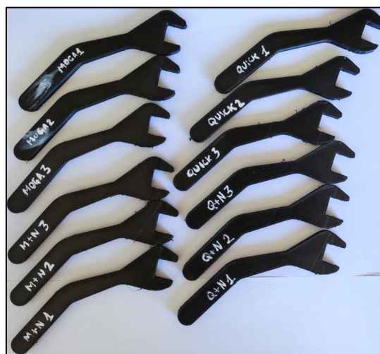
Figure 67 : Clés imprimées avec la Markforged X7 pour la réalisation de l'essai.
