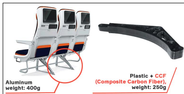
Figure 2 : Allègement d'un support de siège d'avion grâce aux nouveaux procédés de FA (extrait de [Ani2023]).
