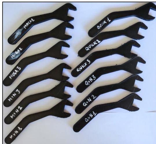
Figure 67 : Clés imprimées avec la Markforged X7 pour la réalisation de l'essai.
