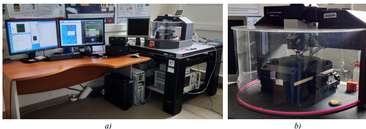
Figure 41. Microscope micro-ondes (SMM), Laboratoire ICB Dijon – a) Installation ; b) Zone de mesures
