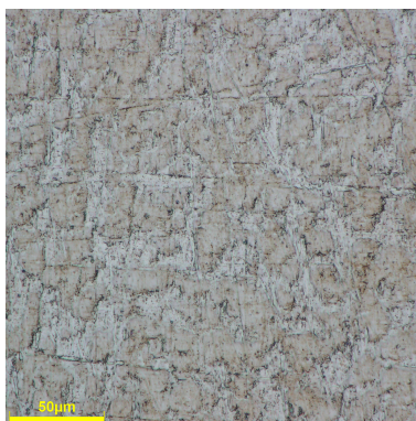
Figure 16. Surface brute d'un échantillon de titane (T40) étudié
