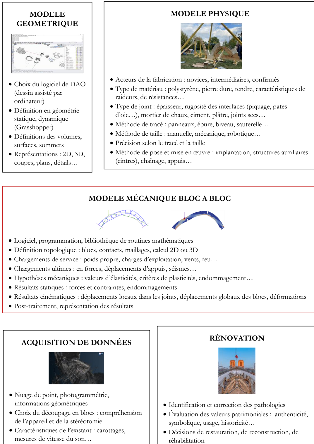
Figure 3.2 – Problématiques attachées aux catégories appartenant à un contexte de conception ou de rénovation de structures bloc à bloc ; le contour de ce travail est constitué par le modèle mécanique bloc à bloc, entouré en rouge
