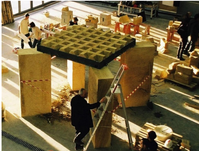
Figure 1.25 - Plancher fragmenté plat conçu d'après l'invention d'Abeille, expérimentation constructive aux Grands Ateliers (Sakarovitch 2006)
