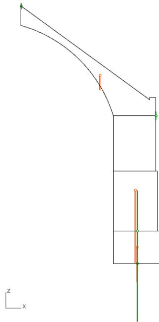
Figure 11.18 – Distribution d'efforts aux joints simplifiée obtenue pour le calcul de la poussée passive en analyse limite, égale à 0.0 kN, avec \mu = \infty et sans critère de limite finie en compression (critère d'Heyman)
