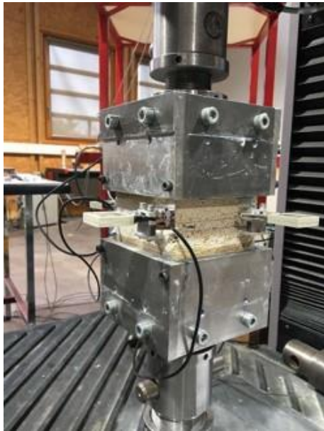
Figure 2.4 - Essai de traction sur un module pierre-mortier-pierre (Venzal 2020) et schéma de principe
