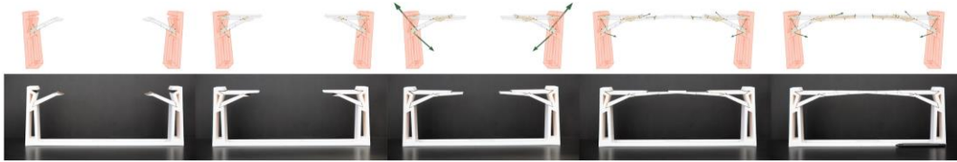
Figure 2.17 – Phasage du montage d'une structure bloc à bloc, au sein de l'environnement de travail COMPAS, tiré de (Kao et al. 2022)
