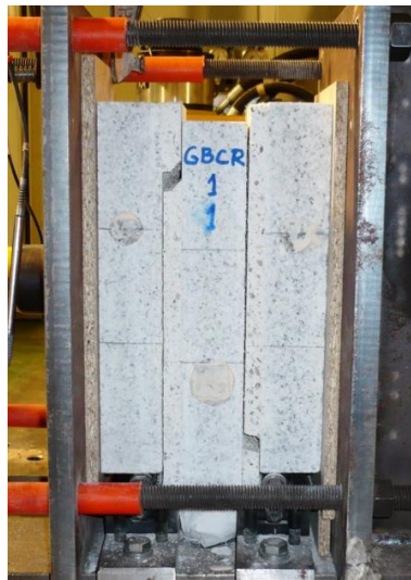
Figure 2.8 - Rupture visible de l'interface entre le bloc de pierre et le joint de mortier après une sollicitation en cisaillement (Roca 2018)
