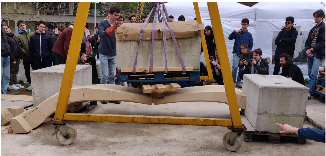
Figure m – Mise en rupture de la passerelle avec un bloc de béton d'environ 1.5 tonnes, appliquant une charge ponctuelle à la clé
