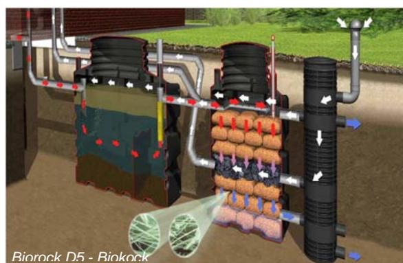
**Figure I- 8. Exemple de procédés compacts à base de laine de roche (Biorock, 2012)**
