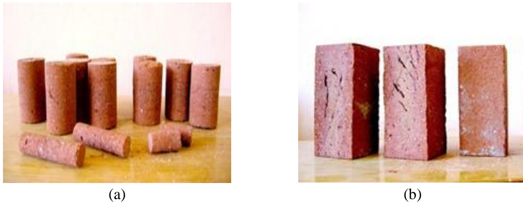
Figure 1.2 : (a) Briques carottées 3×5 cm, (b) Briques sciées 5×5×10 cm [14]
