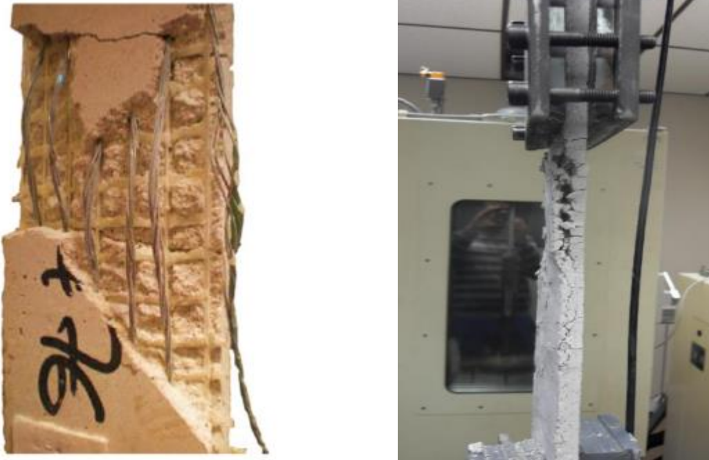
Figure 1.18 : Rupture par délaminage des TRM [38], [44]
