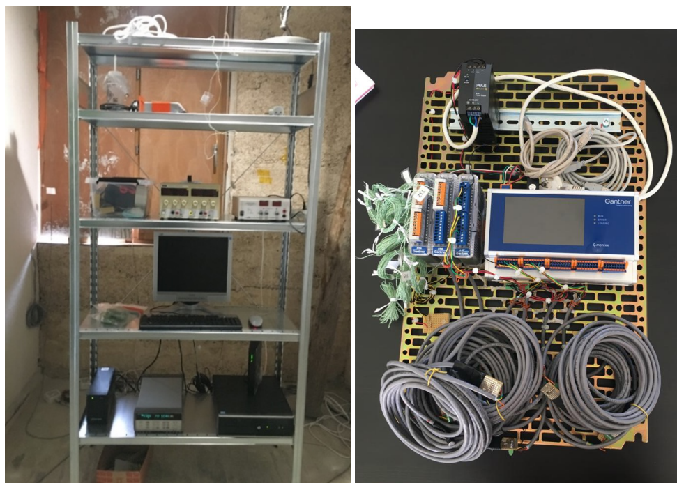
Figure 3.10 – Dispositifs expérimentaux pour la récupération des données au R+1 (à gauche) et au R+2 (à droite) (Malagoli de Almeida, 2022)
