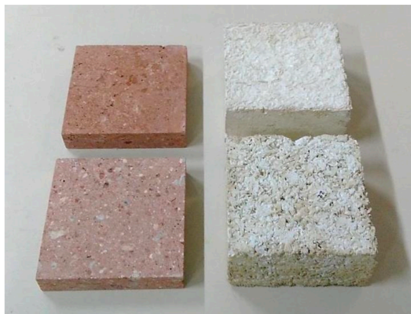
Figure 3.14 – Échantillons utilisés pour la caractérisation de la brique du 16 ème siècle (en haut à gauche) et pour le mélange chaux-chanvre (en bas à droite) (Claude, 2018)
