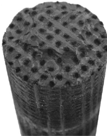
Fig. 1.3. Structure d'un matériau composite C/C d'un bouclier thermique [YZX + 09].
