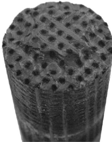
**Fig. 1.3.** Structure d'un matériau composite C/C d'un bouclier thermique [YZX<sup>+</sup>09].
