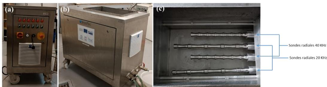
**Figure 3:** (a,b) La cuve multifréquence, (c) Les sondes radiales à l'intérieur de la cuve.
