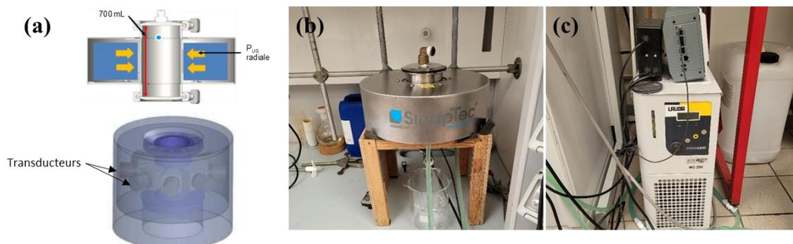
**Figure 2:** (a) Schéma représentatif de la canalisation ultrasonique, (b) Dispositif Ultrasonic Lab750 SinapTec utilisé dans cette étude, (c) Réfrigérant et générateur Nextgen.
