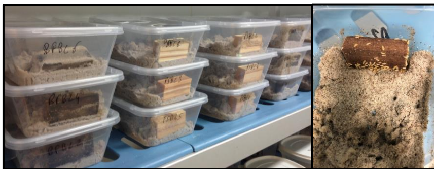
Figure 8. Dispositifs d'essais face aux termites (ORLAT)
