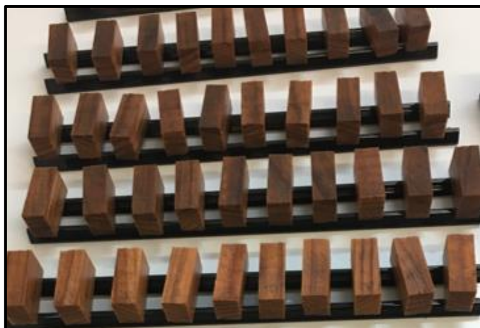
Figure 7. Séchage des éprouvettes après délavage
