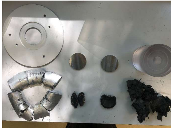
Figure 3-18 : Etat avant et après le test d'impact de plaques de l'ensemble cible (gauche), du support en aluminium et du projectile (droite) incluant la plaque impactrice et le sabot
