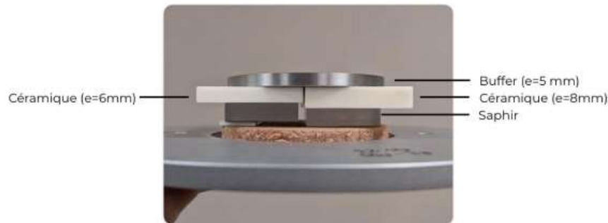
Figure 4-1 : Photographie du montage vu de profil obtenu pour réaliser une analyse Lagrangienne à partir d'un essai d'impact de plaques
