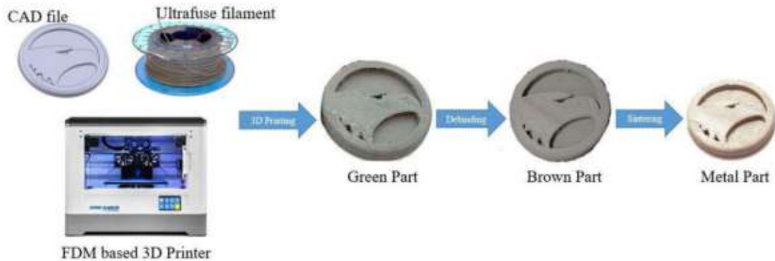
Figure 3-14 : Présentation de la technique d'impression FDM
