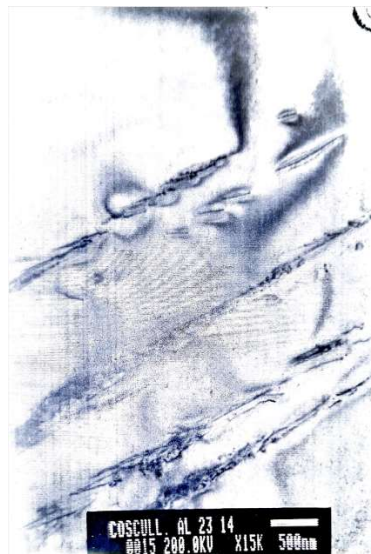
Figure 2-21 : Image obtenue par microscopie électronique par transmission de dislocation au sein d'une alumine
