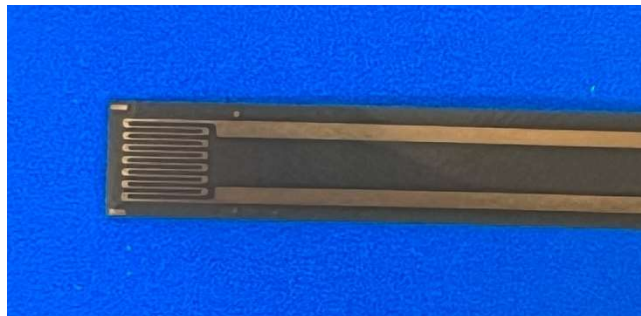
Figure 5-1 : Photographie de la jauge utilisée Vishay J2M-SS-110FB-048
