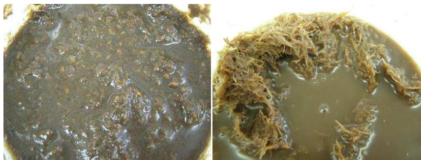
Figure III-23: Extrudats de coproduit de maïs doux et de Pinzote neutralisés en extrudeuse bi-vis
