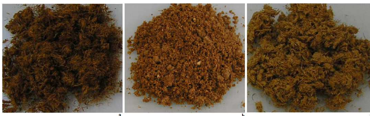
Figure III-20: Extrudats prétraités en traitement alcalin en bi-vis (a): bagasse d'agave, (b): coproduit de maïs doux, (c): Pinzote
