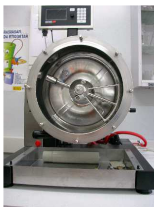
Figure IV-35: Bioréacteur (Terrafors, Infors-HT, Suisse) utilisé par le CIEMAT pour les hydrolyses à haute consistance
