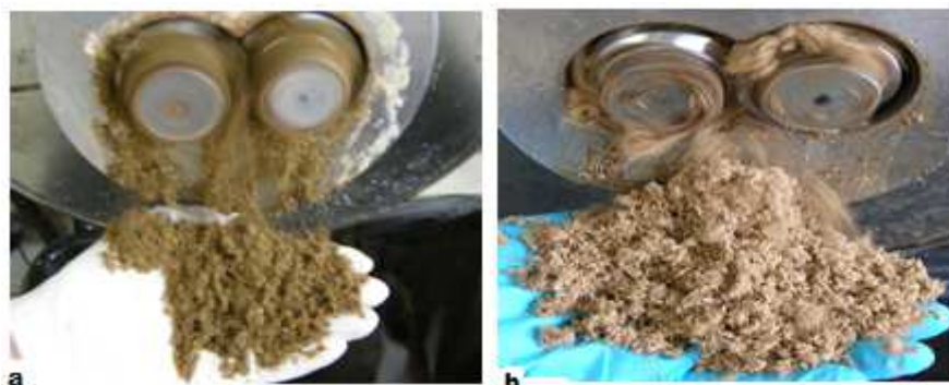
Figure III-27: Extrudats neutralisés de coproduit de maïs doux (a) et de Pinzote (b)
