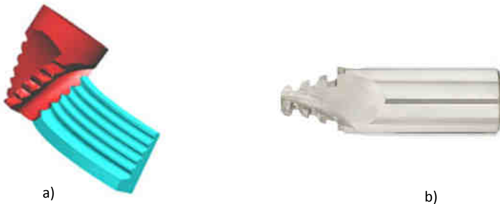
figure II-3 a) Fraisage d'alvéole courbe b) Fraise pied de sapin d'après Seco®
