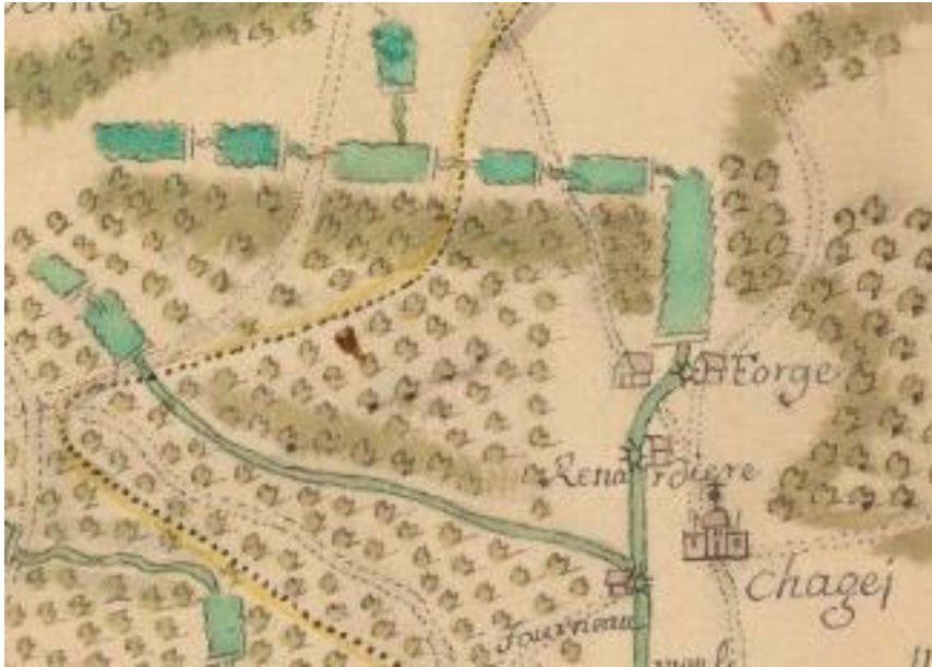
Fig. 5. Les chaînes d'étangs en amont de la forge de Chagey. Bib. nat.
