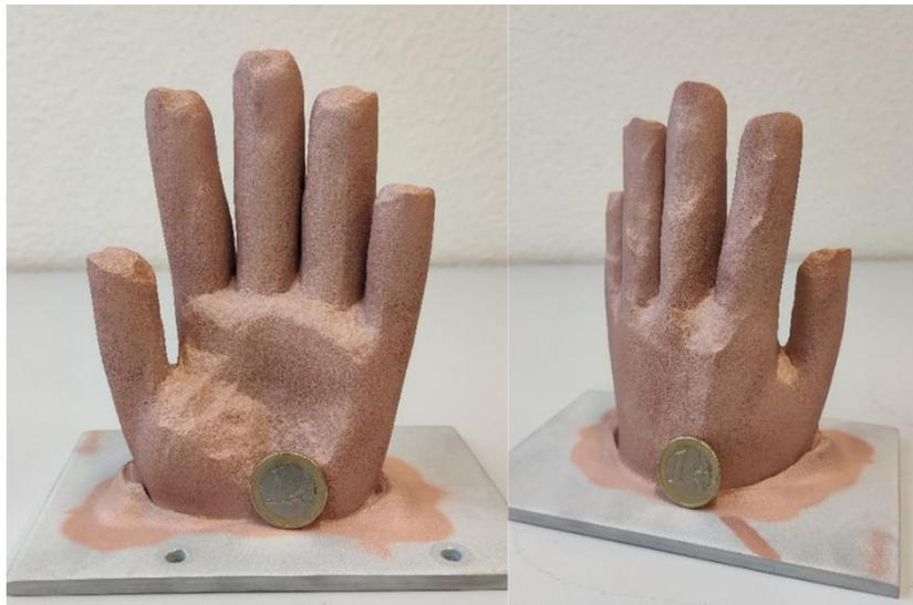
Figure 5.20 Vue d'une main en cuivre élaborée par projection cold-spray.
