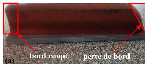
Figure 4.15 Profil d'un dépôt élaboré après 20 couches.
