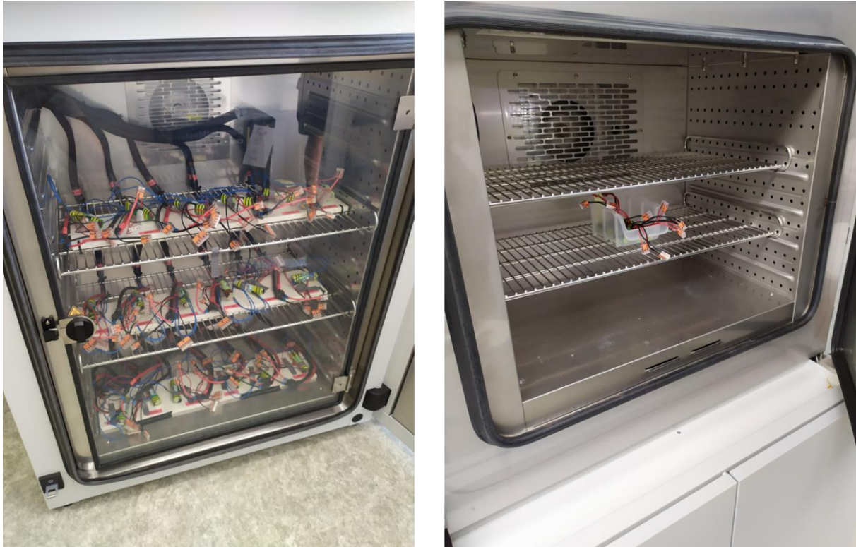
Figure 41 : Aperçu des cellules installées dans les enceintes thermiques. A gauche est présentée l'enceinte thermique à 25°C contenant les caractérisations périodiques (étagère du haut), le cyclage à courant constant (étagère du milieu) et le cyclage en puissance (étagère du bas). A droite sont présentées les cellules stockées à 60°C, les stockages à 40°C et 25°C sont identiques.
