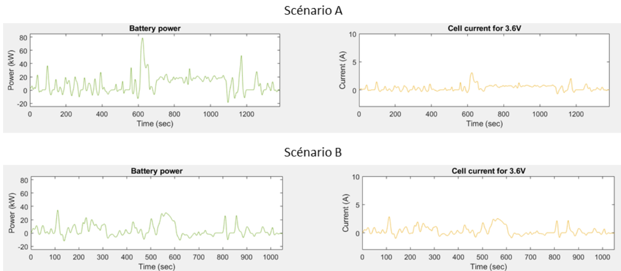
Figure 47 : Profils de puissance batterie et de courant équivalent à l’échelle de la cellule pour les scénarios A et B
