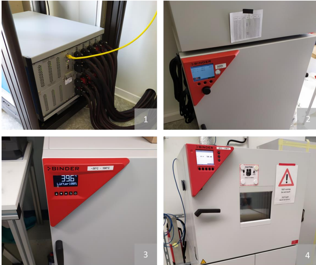
Figure 40 : Aperçu des équipements de test utilisés au Batterietechnikum. On retrouve en 1) le testeur, en 2) l'enceinte thermique à 25°C, en 3) l'enceinte thermique à 40°C et en 4) l'enceinte thermique à 60°C.
