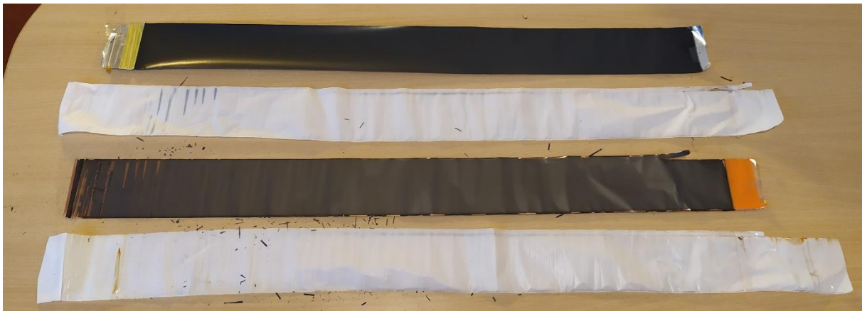
Figure 3 : Accumulateur cylindrique (format 18650) hors de son boîtier. Les différentes parties qui le constituent sont visibles (de haut en bas) : électrode positive, séparateur n°1, électrode négative, séparateur n°2. Le tout se présente sous la forme de longues bandes fines. Elles sont superposées et roulées à l'intérieur du boîtier.
