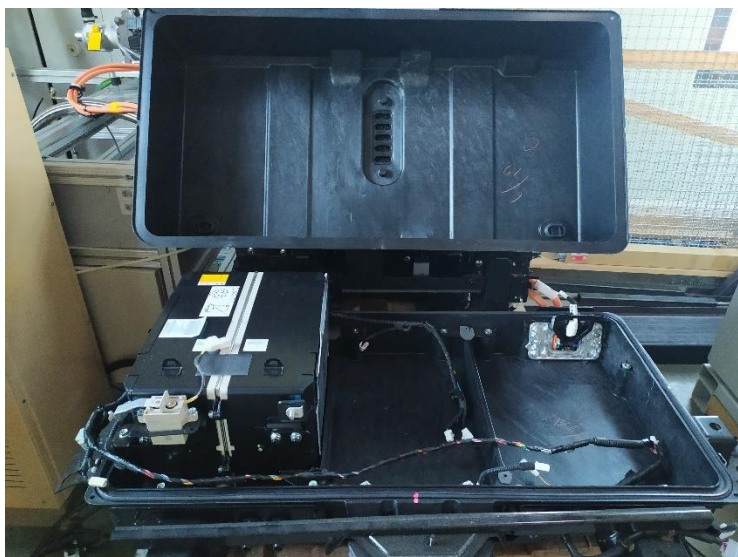
Figure 12 : Ouverture d'un pack batterie Peugeot. Un de ses trois modules est visible à gauche.
