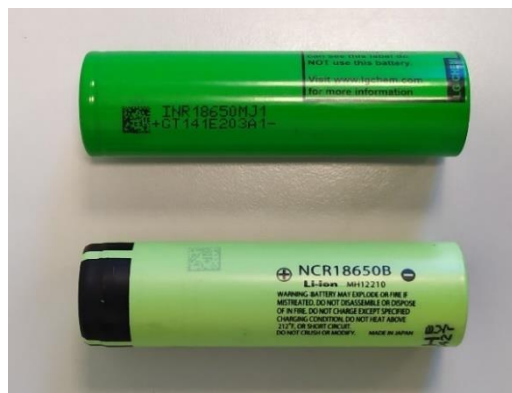
Figure 35 : Aperçu des cellules testées. LG MJ1 en haut et Panasonic B en bas.
