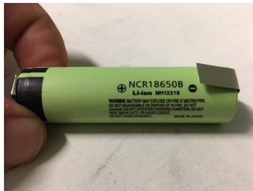
Figure 36 : Aperçu d'une cellule testée au Batterietechnikum munies de languettes de connexions
