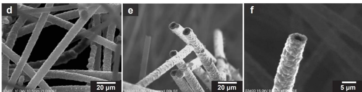
Figure I-18 : Clichés MEB de fibres de BDD (Kondo, Kodama, and Yuasa 2012)
