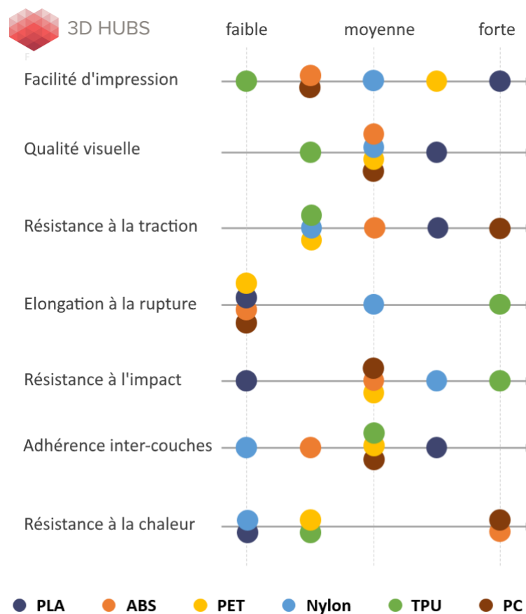
FIGURE A.1: Comparaison des matériaux imprimables selon différents critères. Source Filimprimante3D (2022b)
