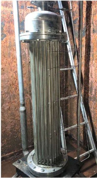
Figure 41 : Banc d'essais expérimental d'un système de refroidissement d'une piscine de réacteur calogène [79]
