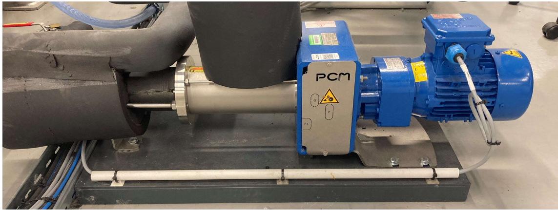
Figure 124 : Pompe à vis excentrée du banc d'essais AMORCE_2
