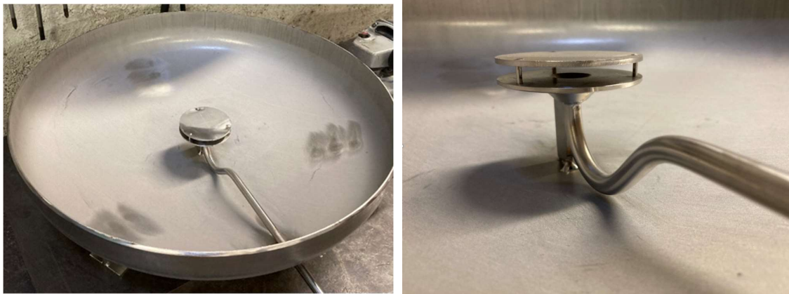
Figure 62 : Photo de l'injecteur double plaque de l'évaporateur immergé
