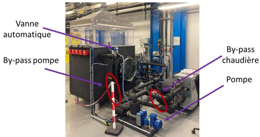
Figure 64 : Circuit d'eau cuve - évaporateurs à plaques
